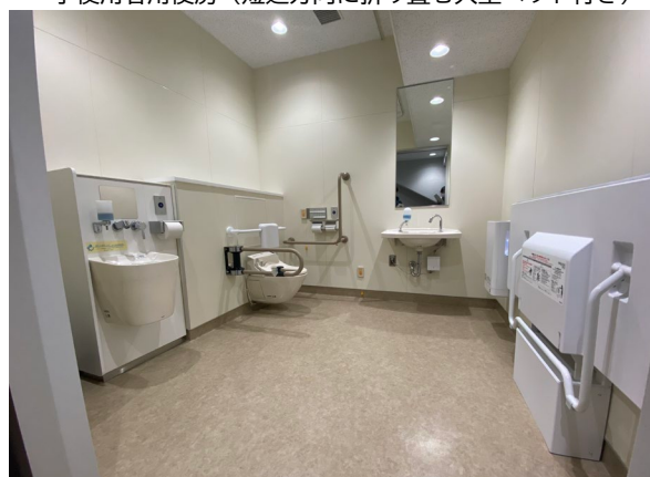
・直径180cm以上の円が内接できるスペースを有する車椅子使用者用便所（長辺方向に折り畳む大型ベッド付き）
